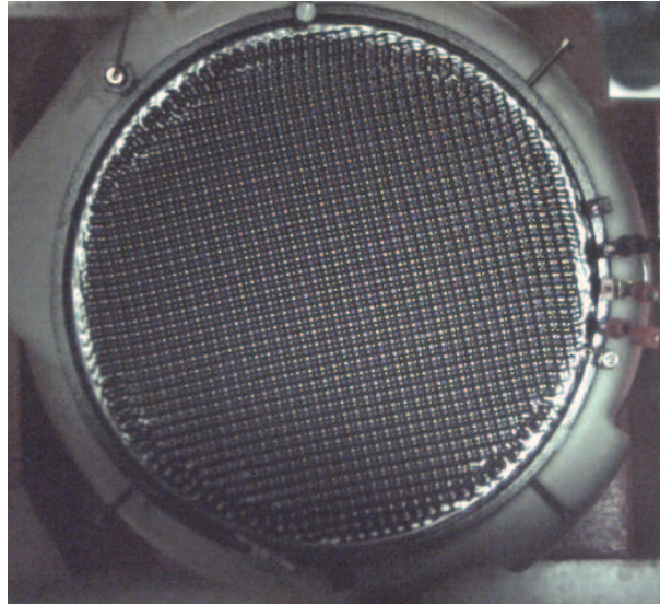
Figure 5.9 – Ondes stationnaires à la surface d'une cuve d'eau, accélérée sinusoidalement à 80 Hz par un pot vibrant. Le motif présente une longueur d'onde caractéristique égale à la longueur d'onde de Faraday (environ 5 mm). La cuve fait 22 cm de diamètre.
