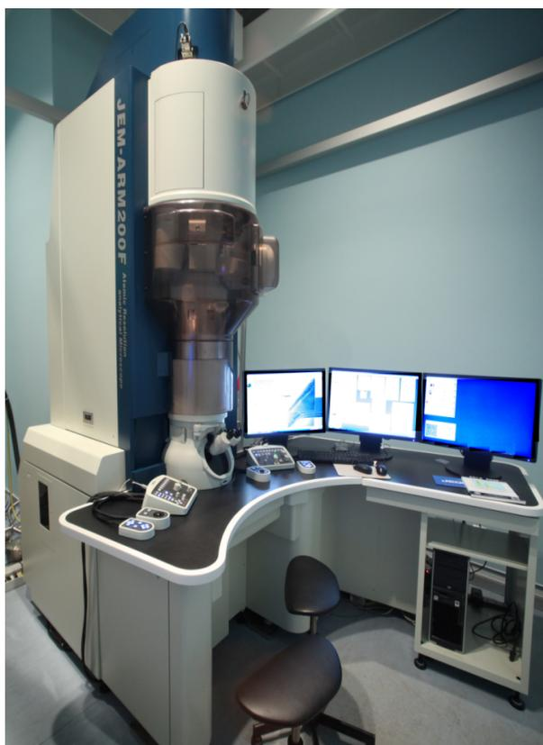
FIGURE 2.5 – Photographie du microscope électronique en transmission JEOL ARM-200F, corrigé des aberrations sphériques de la lentille objectif.
