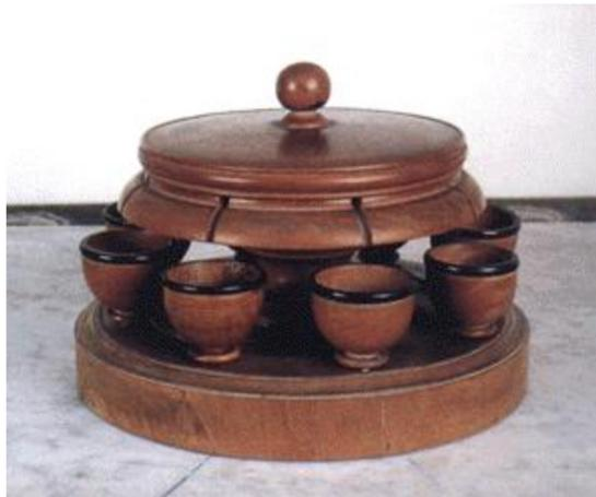
FIGURE 1.19 – Sismomètre inventé par Jean de Hautefeuille en 1703. Il s'agit d'un instrument en bois contenant un socle circulaire d'un diamètre de 12 cm. La coiffe est remplie de mercure et 8 gouttières y sont installées sur les 4 points cardinaux et 4 directions intermédiaires. Dessous, 8 récipients sont disposés pour récupérer le mercure lorsque celui-ci est déversé, c'est-à-dire en cas de mouvement sismique.
