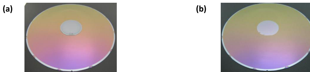
Figure 2.3 : Photographie d'une plaque III-V (50 mm) reportée sur une plaque Si (200 mm) (a) après collage et (b) après retrait du substrat d'InP.
