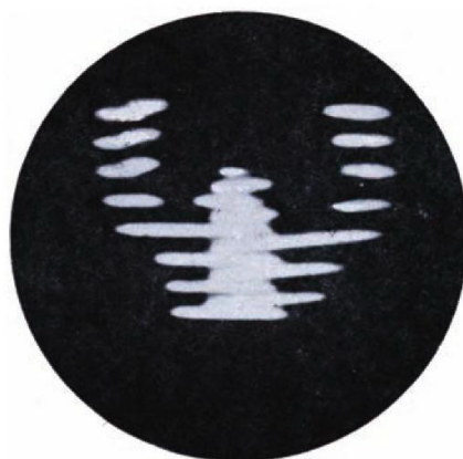
FIGURE 2.5 – Photographie du professeur Andrews en train de lever les bras prise dans le noir avec la caméra infrarouge de son invention en 1946. La caméra est constituée d'un objectif à deux miroirs dont l'un des deux pivote pour balayer le champ de vue. Les rayons infrarouges sont focalisés sur un bolomètre supraconducteur de nitrure de niobium (NbN) refroidi à l'hydrogène liquide à 14 K. Les fluctuations de température mesurées par le thermomètre font varier le courant électrique communiqué à un tube cathodique dont le balayage du faisceau est synchronisé sur celui du miroir. Ainsi il était possible de visualiser en temps réel les émissions infrarouge de l'environnement sur un écran à la manière des oscilloscopes et anciens téléviseurs ( Crédit : Popular Science, juill. 1946, p. 127 ).
