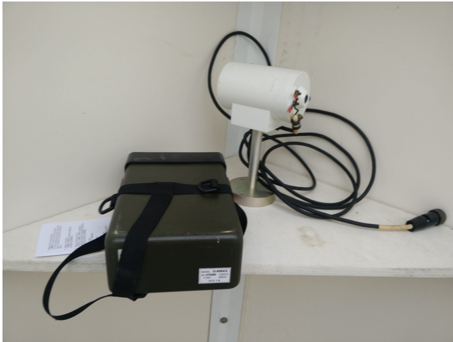
FIGURE 1.9 – Magnétomètre RMN à précession libre. Crédits : Ted Luc (IPGP).
