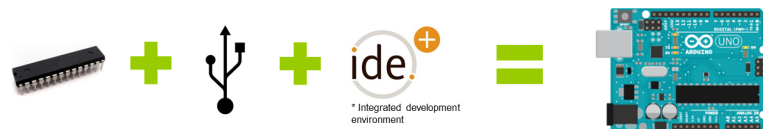
FIGURE I.2.18 – Association d'un micro-contrôleur, d'une connexion à l'ordinateur (USB) et d'une interface de programmation adaptée donnant une solution de prototypage de projets électroniques simples et faciles d'accès
